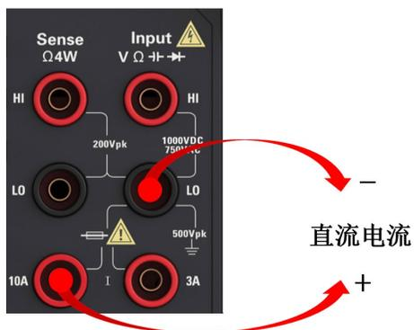
**注意：**为了避免损坏万用表，请务必遵循如下提示进行直流/交流电流测量。
