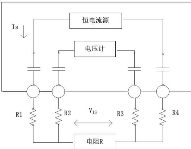
图 11.1 交流四端子测量法原理图
