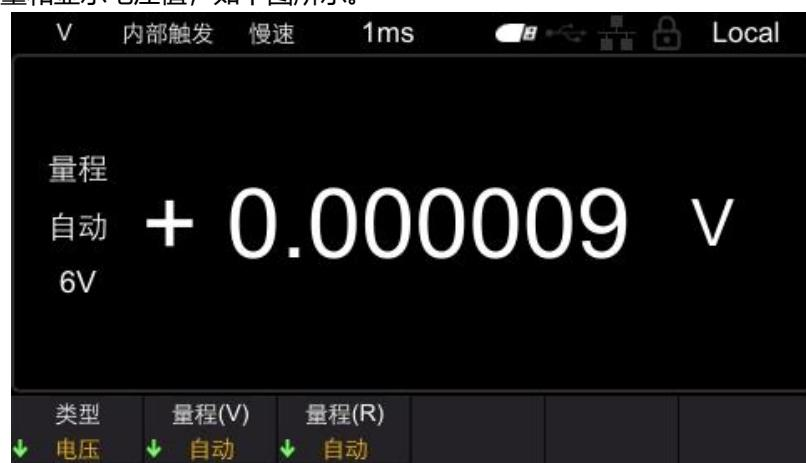
图 5.2 测量电压界面
