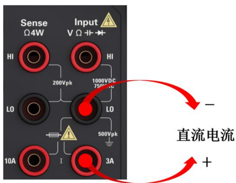
直流/交流电流测量（小电流）
