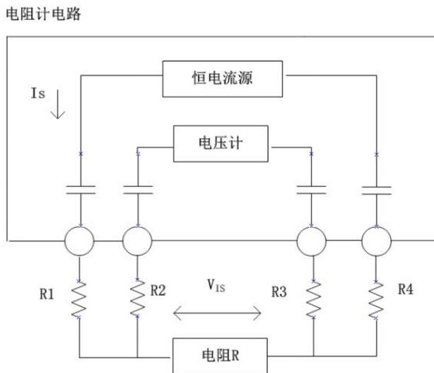
图 11.1 交流四端子测量法原理图
