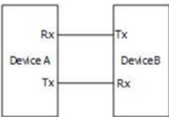
图 14.1 UART 串行总线示意图
