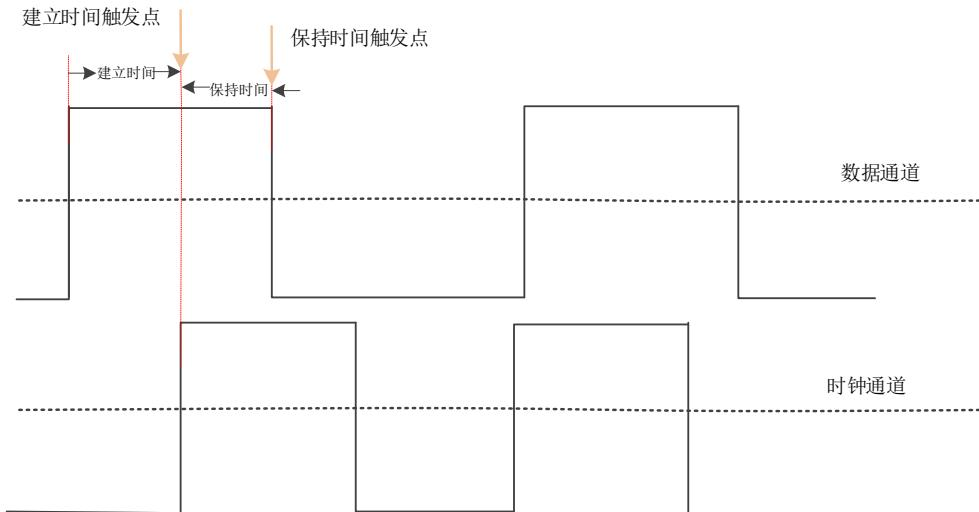
图 8.13 建立保持触发示意图
