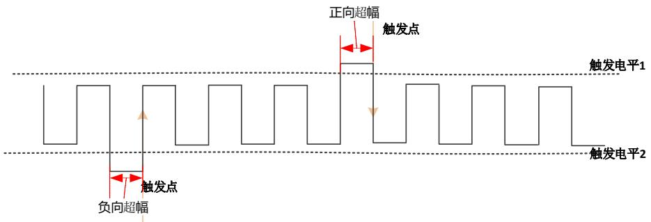
图 8.10 超幅触发示意图
