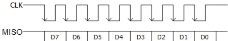
图 8.17 SPI 触发示意图
