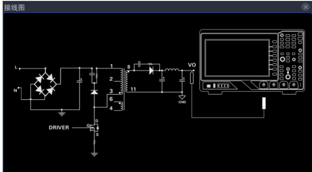
图 17.2 纹波接线图
