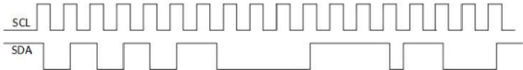
图 14.4 I2C 串行总线示意图
