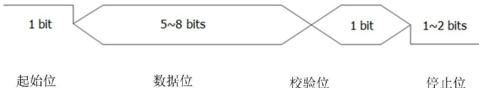
图 8.14 UART 触发示意图
