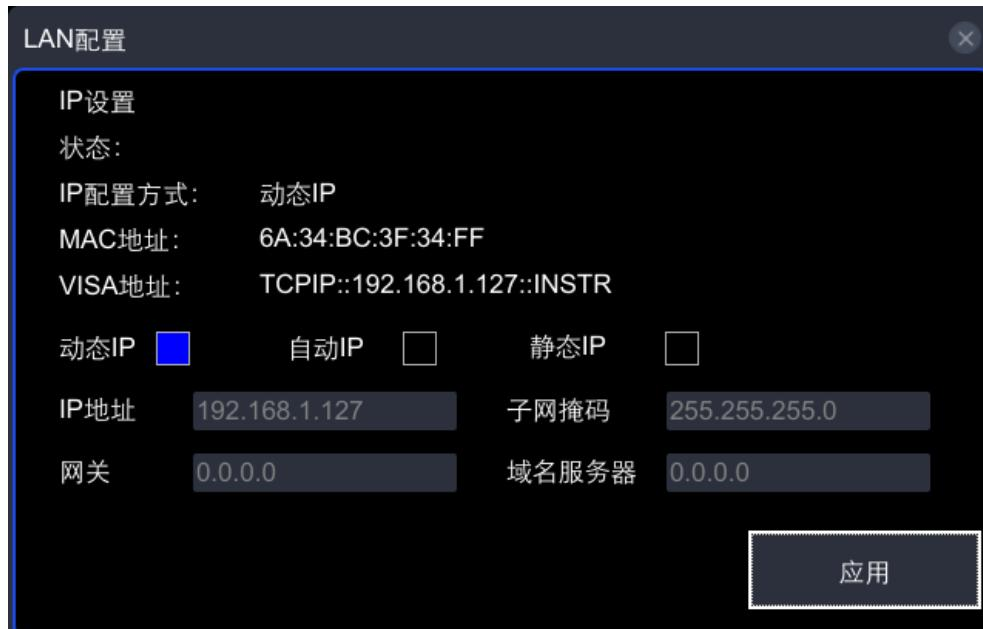
图 13.1 LAN 连接设置界面
