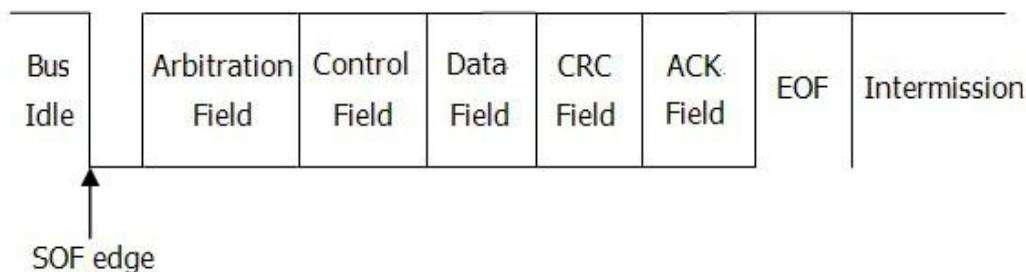
图 8.16 CAN 总线示意图
