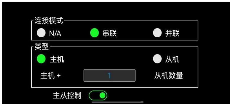
设置主机，连接模式选择串联，类型选择为主机，主机 + 1 从机表明两台电源串联或并联，有一台从机，主从控制打开。
