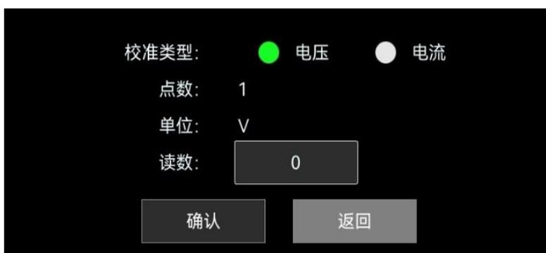
**电压校准：**首先将电源停止输出，再将电源正负接入万用表。选择校准类型为 电压，将万用表显示的数值填入，点击确定，会自动跳入另一个校准点。继续填入数值，点击确定。电压校准点共 8 个，第 8 个点输入完成并确定后， 会变成 ，表示校准电压完成。
