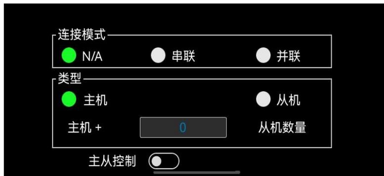
**Menu** > **串联/并联** 进入串并联界面。本系列电源最多可以 2 台完全相同的设备串联。
