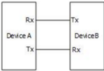
图 14.1 UART 串行总线示意图
