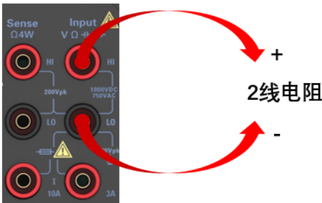
图 9.21 2 线电阻连接图
