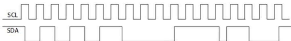
图 14.4 I2C 串行总线示意图
