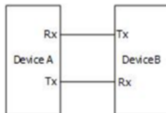
图 14.1 UART 串行总线示意图
